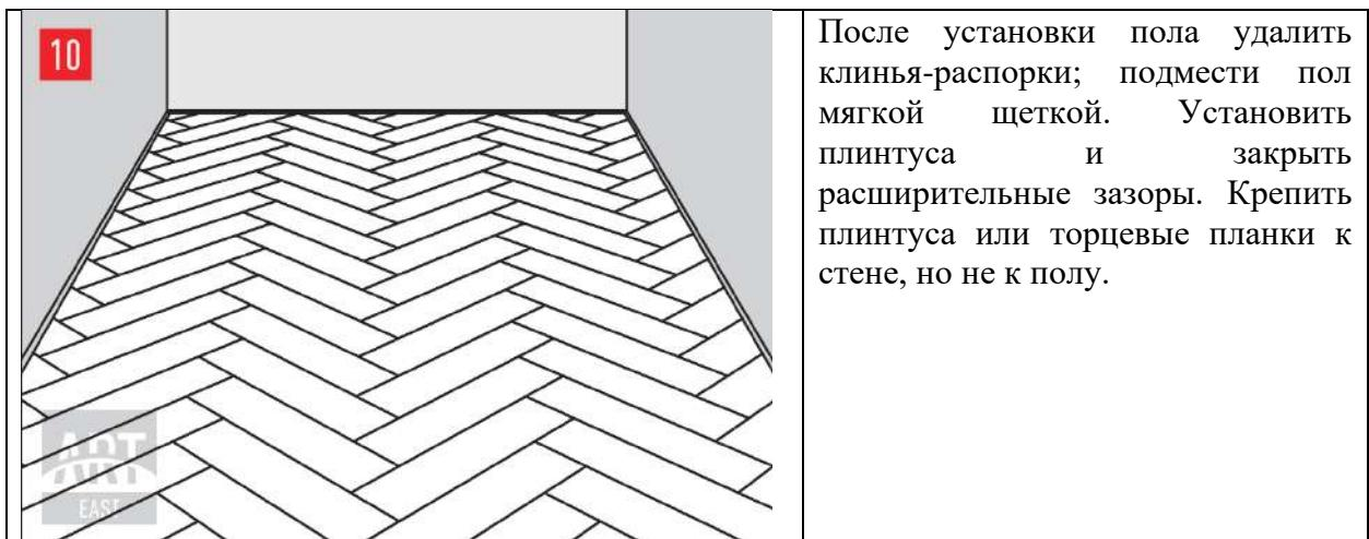
После установки пола удалить клинья-распорки; подмети пол мягкой щеткой. Установить плинтуса и закрыть расширительные зазоры. Крепить плинтуса или торцевые планки к стене, но не к полу.
